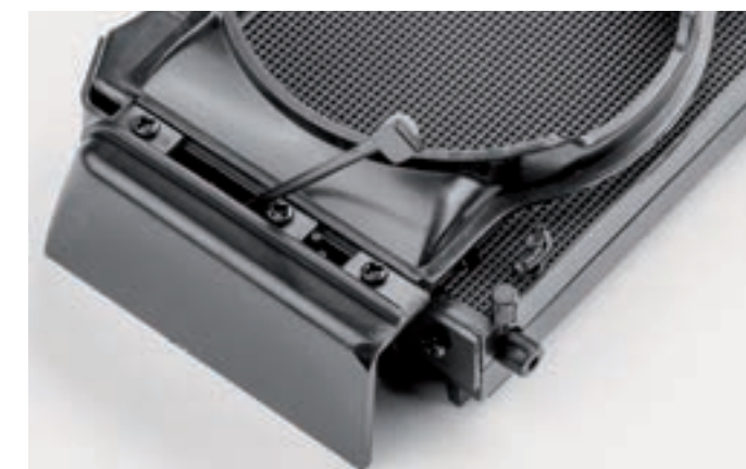
Шаг 8. Аналогичным образом установите и закрепите левый кожух радиатора. Для фиксации детали используйте три винта 1,7×5 (JP).
