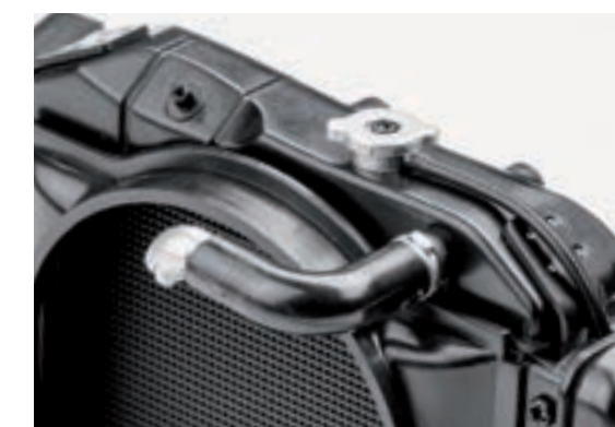
Шаг 9. Закрепите верхний шланг радиатора на крепежном штифте, расположенном в верхней части радиатора возле заливной горловины.
