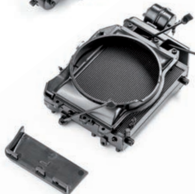
Шаг 8. Аналогичным образом установите и закрепите левый кожух радиатора. Для фиксации детали используйте три винта 1,7×5 (JP).
