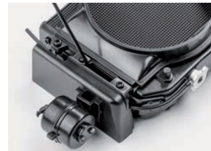
Шаг 7. При помощи двух винтов 1,7×5 (JP) зафиксируйте правый кожух радиатора поверх центрального кожуха. При этом переливная трубка радиатора должна пройти между правым кожухом и самим радиатором, а правая стяжная планка расположиться между верхней и средней крепежной проушиной кожуха.
